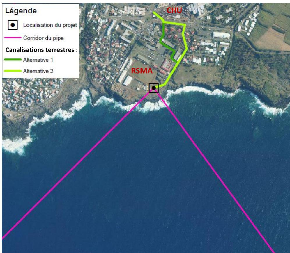
Figure 2 – Corridor canalisations marines et options canalisations terrestres
