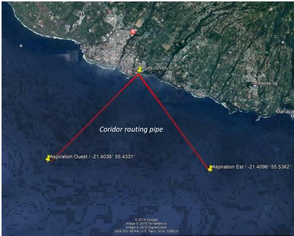
**Figure 5 : Corridor des conduites d'aspiration et de rejet**
